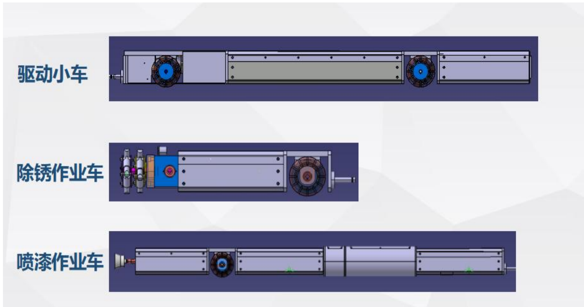
图 2 内补口机器人主要机构示意图
